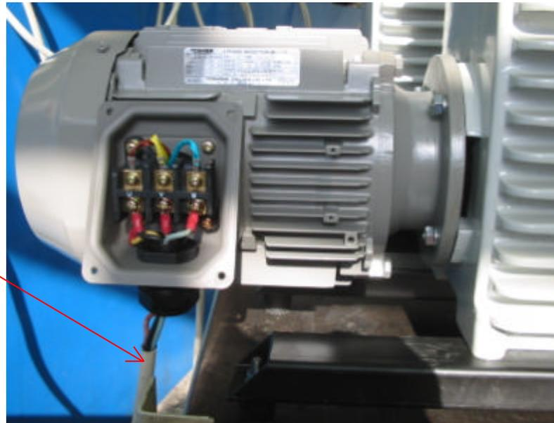
**注意：在连接电机或更改连接后必须检查旋转方向。为此可很短暂地合上电机电源开关，观察在进气口上的盖板是否被吸住。否则更换任意两个相线的连接。长时间反转会造成泵损坏。**
