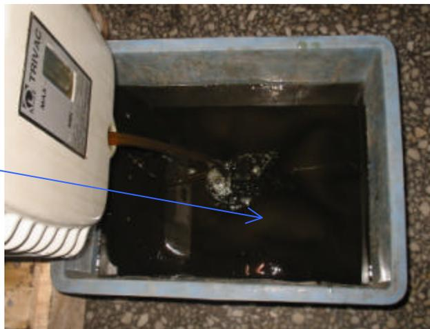
换油方法：需用工具为内六角扳手8毫米。
