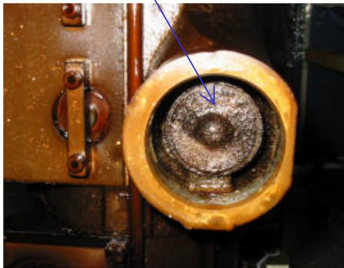
防返油阀阀面破损，造成停泵时不能使与之相连的容器保持真空。
