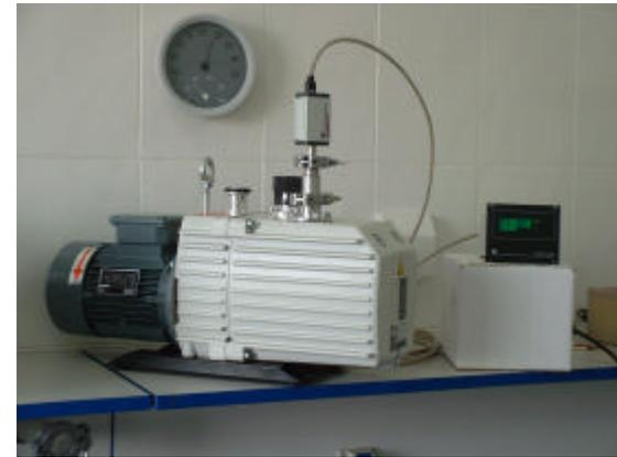
**规管安装位置：**原则上应尽可能的把规管安装在接近被测量的部位。但是，真空系统中影响测量的因素很多。当测量系统时，有时在规管与被测容器之间连接管道、阱或过滤器。这样就会因流导的影响而造成测量误差。
