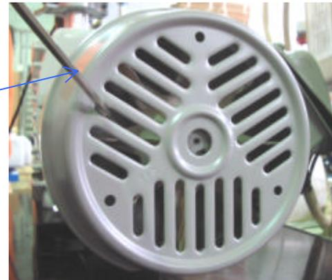
注意：如泵在运转中发现电机风扇不转、电机过热，请及时关闭电机电源以免电机烧毁。
